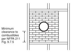
FIGURE 9 - UL LISTED WALL PENETRATION
