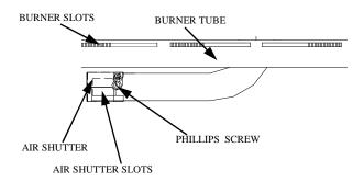
FIGURE 21 - BURNER/ AIR SHUTTER
