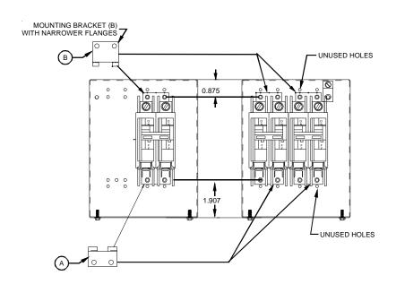
Figure 2 PROPER ORIENTATION FOR HEAT KITS **USING SIEMENS BREAKERS**
