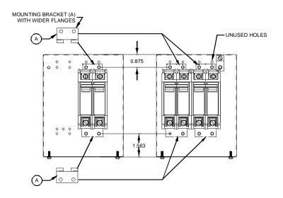
Figure 1 PROPER ORIENTATION FOR HEAT KITS USING G.E. BREAKERS
