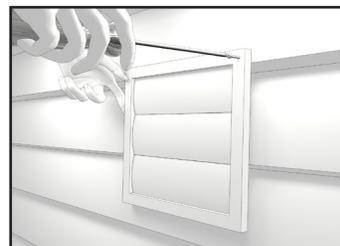
**3** Enfoncez la hotte dans l'ouverture. Fixez la hotte sur le mur extérieur en utilisant des vis de montage. Répétez la procédure d'installation pour la hotte d'aspiration et la hotte d'évacuation.
