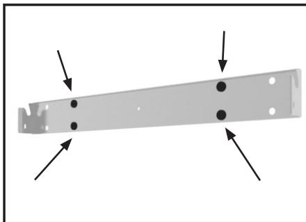
**1** Fixer le support au mur à l'aide de quatre vis et rondelles fournies.
