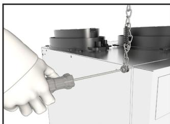
**2** Suspendez la chaîne (fournie) à chaque boulon de 19 mm (3/4 po) (fournis) situés aux quatre coins supérieurs du VRC et serrez.
