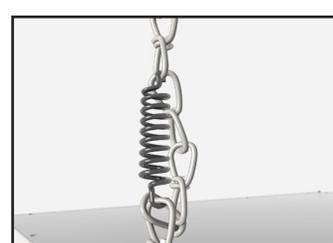
**4** Installez un ressort sur chaque chaîne. Accrochez le ressort de sorte qu'une boucle est créée dans la chaîne. Le ressort supportera le poids du VRC et absorbera les vibrations.
