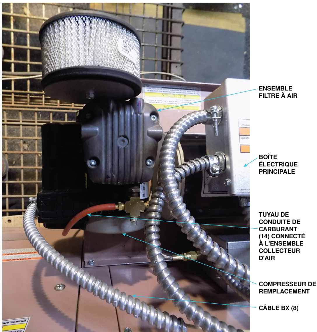
Figure 74. Compresseur de remplacement installé (modèle RAD 500 illustré)
